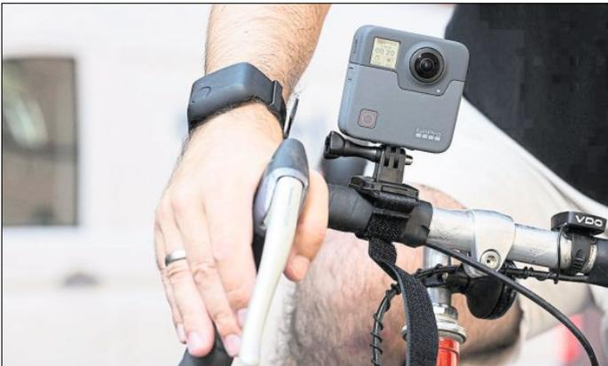
PROBANDEN-AUSRÜSTUNG: Körperliche Stressreaktionen erfasst der Smartband-Sensor, die Videokamera zeichnet gleichzeitig die jeweilige Umgebung auf. Fotos: KIT
